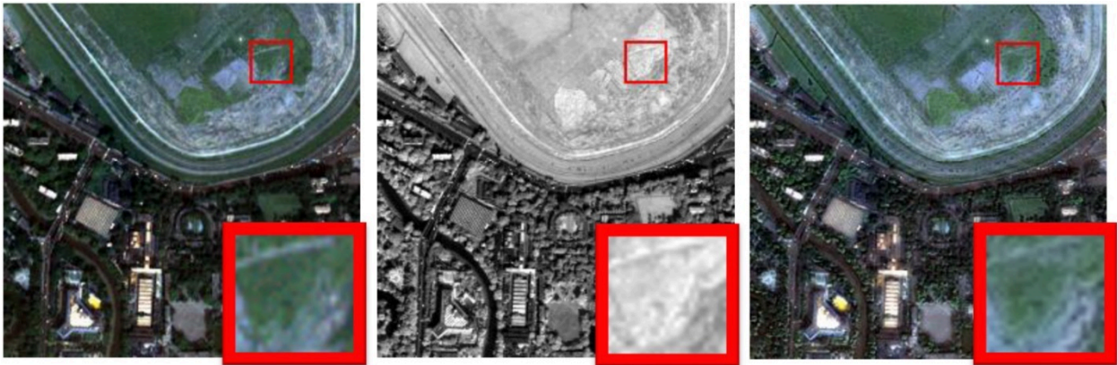
Figure 38: Illustration du pan-sharpening avec une image QuickBird. L'image en couleurs (à gauche, résolution de 2,4 m) est combinée avec l'image pan-chromatique (au centre, résolution de 60 cm) pour produire l'image pan-sharpened (à droite). Two-Path Network with Feedback Connections for Pan-Sharpening in Remote Sensing (Figure 7) par Fu et al, CC BY 4.0 .
